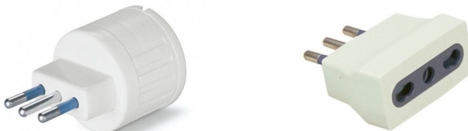
È evidente che, se una spina da 16A si adatta ad una presa da 10A, nel caso di assorbimento di 16A da parte dell'utilizzatore collegato alla spina da 16A, risulterebbe che la presa da 10A è sovraccaricata di più del 50% di quanto possa tollerare. Di conseguenza la presa si surriscalda, fonde e provoca un corto circuito ed un inevitabile incendio.
